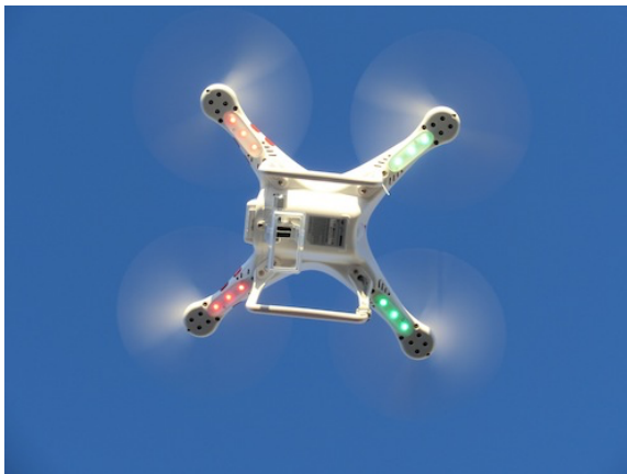
Figuur 2.1 Voorbeeld van quadro-kopter drone (DJI Phantom).
